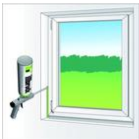
Ilustracja 3: Wypełnić pianką fugę okienną
